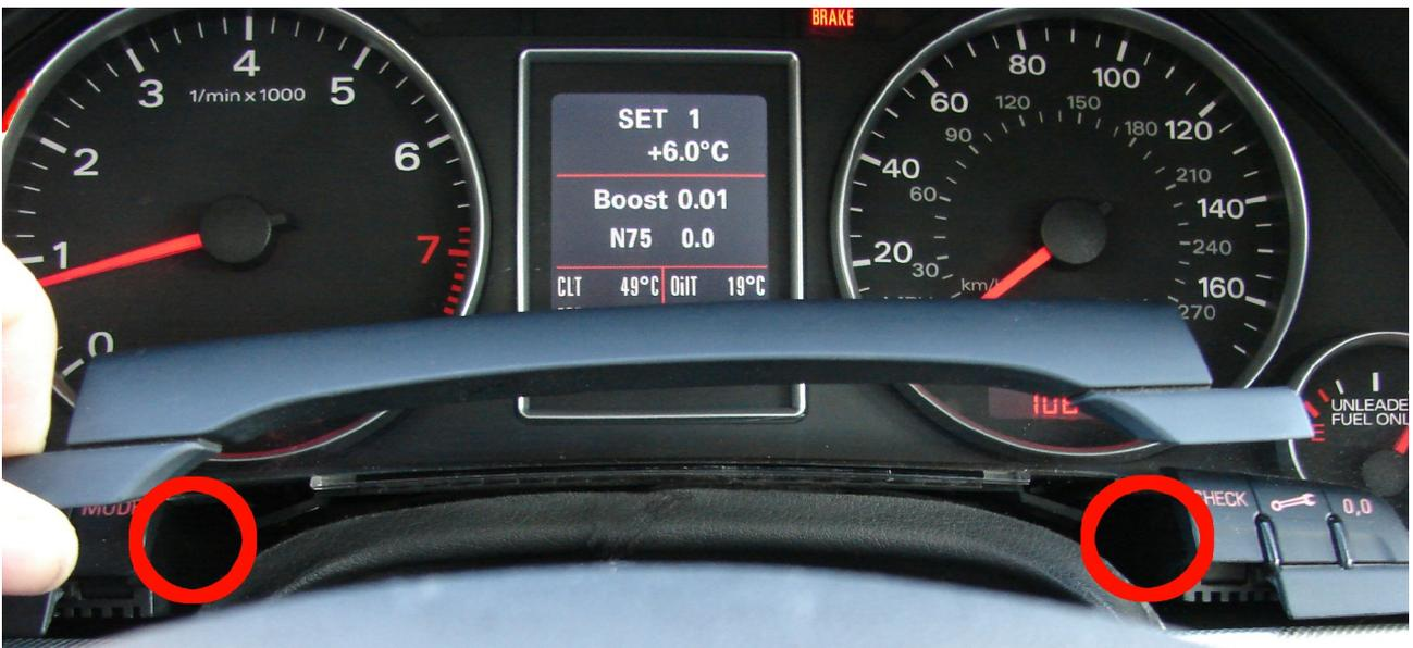
Bild 1: Kombiinstrument- Entfernen der Abdeckung
